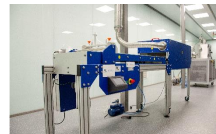
Fot. 102 Element do produkcji na ułamkowo techniczną skalę fotowoltaicznego ogniwa tandemowego
