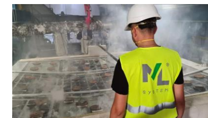
Fot. 8 Sierpień, Pozytywne wyniki badań odporności ogniowej klasy EI30 dla modułów BIPV ML System
